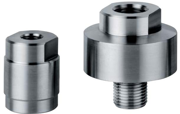
Realizados para aislar el elemento sensible de manómetros y transmisores de presión de fluidos de proceso corrosivos, viscosos y sedimentosos. Una membrana elástica, soldada y cerrada mecánicamente garantiza la separación del fluido de transmisión del de proceso. Las conexiones roscadas nos permite un uso donde es importante las reducidas dimensiones y donde es necesario equipos en DN63.
